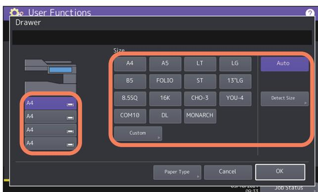
Um die Papiergröße automatisch einzustellen, drücken Sie [Auto] anstelle der Papiergrößetasten. Die Erfassung ähnlicher Papiergrößen kann jedoch zu einer falschen Einstellung führen. Um korrekte papiergrößen einzustellen, drücken Sie [Größe erfasst (Detected Size)] und wählen die korrekte Größe4 für drei Gruppen mit ähnlichen Größen. Wenn Sie die Funktion [Auto] nutzen, werden die richtigen Papiergrößen für die Kassetten eingestellt.
