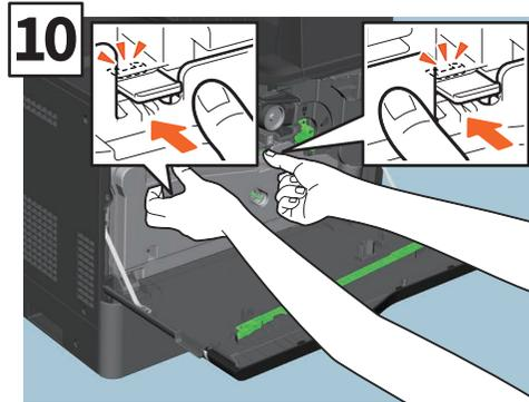
**10** Drücken Sie den Resttonerbehälter vollständig und gerade hinein, bis die oberen Riegel einrasten.
