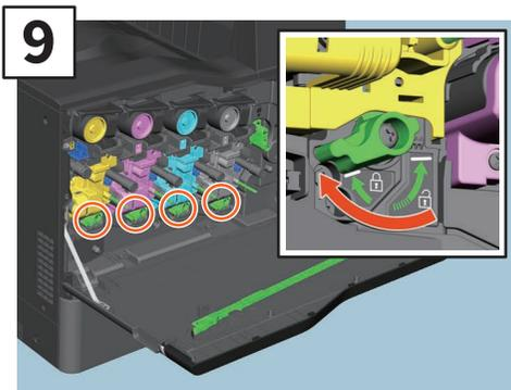
**9** Drehen Sie die vier grünen Hebel in die Verriegelungsposition.
