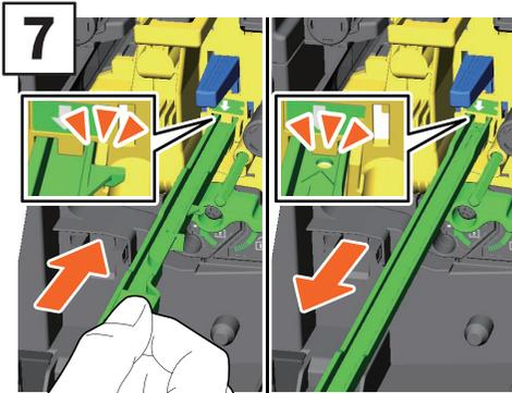
**7** Ziehen Sie den Reiniger zurück, bis die runde Öffnung sichtbar ist. Wiederholen Sie dies dreimal für jede der vier Farben.
