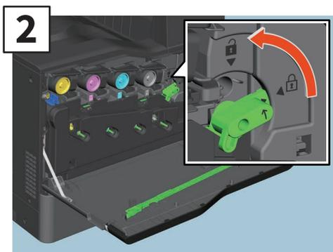
2 Drehen Sie den grünen Hebel, um die Einheit zu entriegeln.
