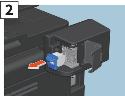
Entfernen Sie das leere Klammermagazin.
