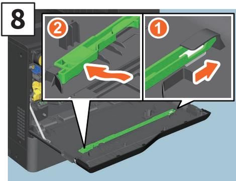
**8** Montieren Sie den Reiniger wieder mit der Oberseite rechts und der Halteseite links.
