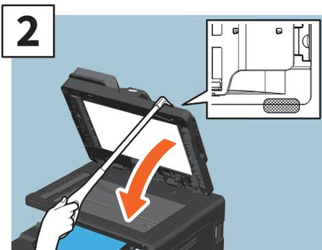
Hängen Sie den Arm in die obere Abdeckung des DADF ein, um sie zu schließen.
