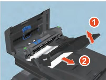
**5 Halten Sie die Führung und entfernen Sie gestaute Originale.**
