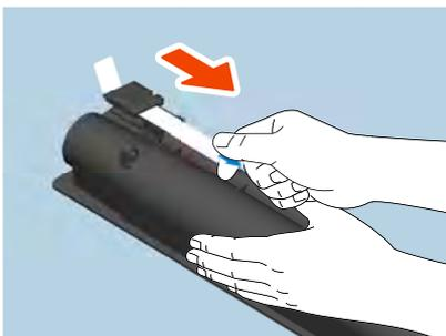
**6 Richten Sie die neue Tonerkartusche an der Führung aus und setzen Sie sie vollständig ein.**
