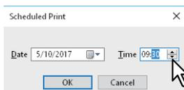
Um die Stunde zu ändern, wählen Sie die Stundenzahl aus und klicken auf das Drehfeld. Um die Minuten zu ändern, wählen Sie die Minutenzahl aus und klicken auf das Drehfeld.
